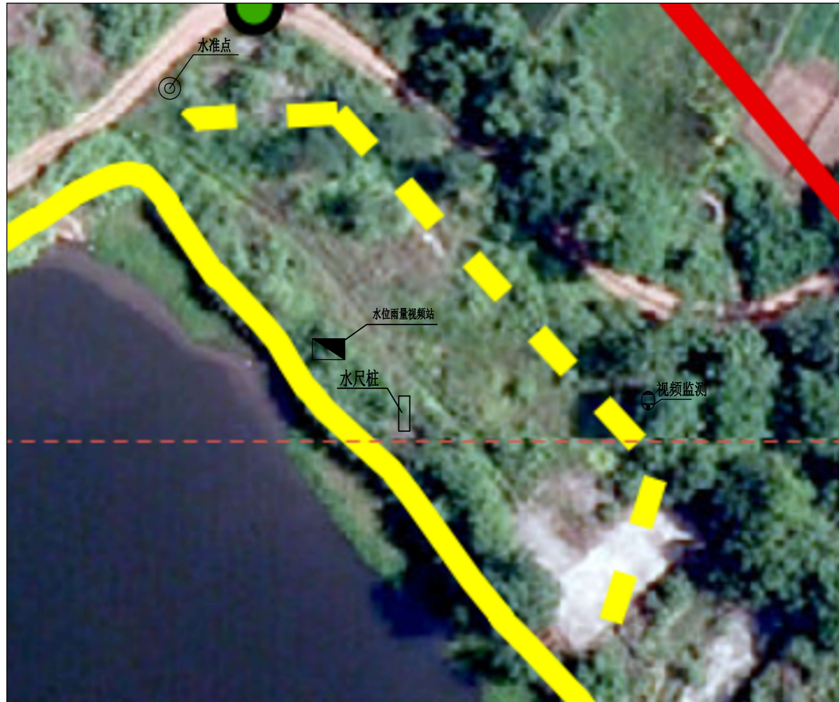
紫山水库雨水情测报平面布置示意图
