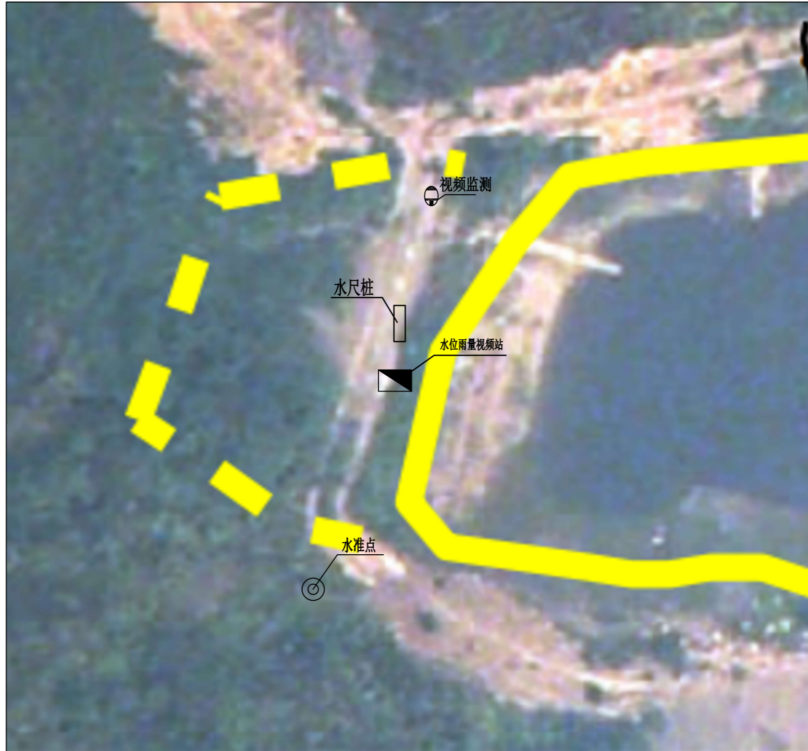
三八水库雨水情测报平面布置示意图
