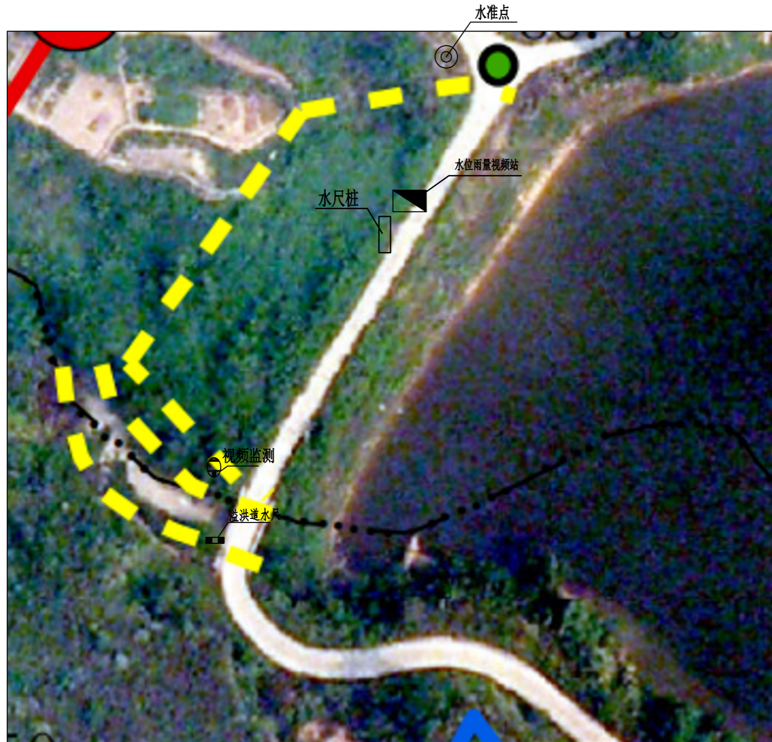
群益水库雨水情测报平面布置示意图
