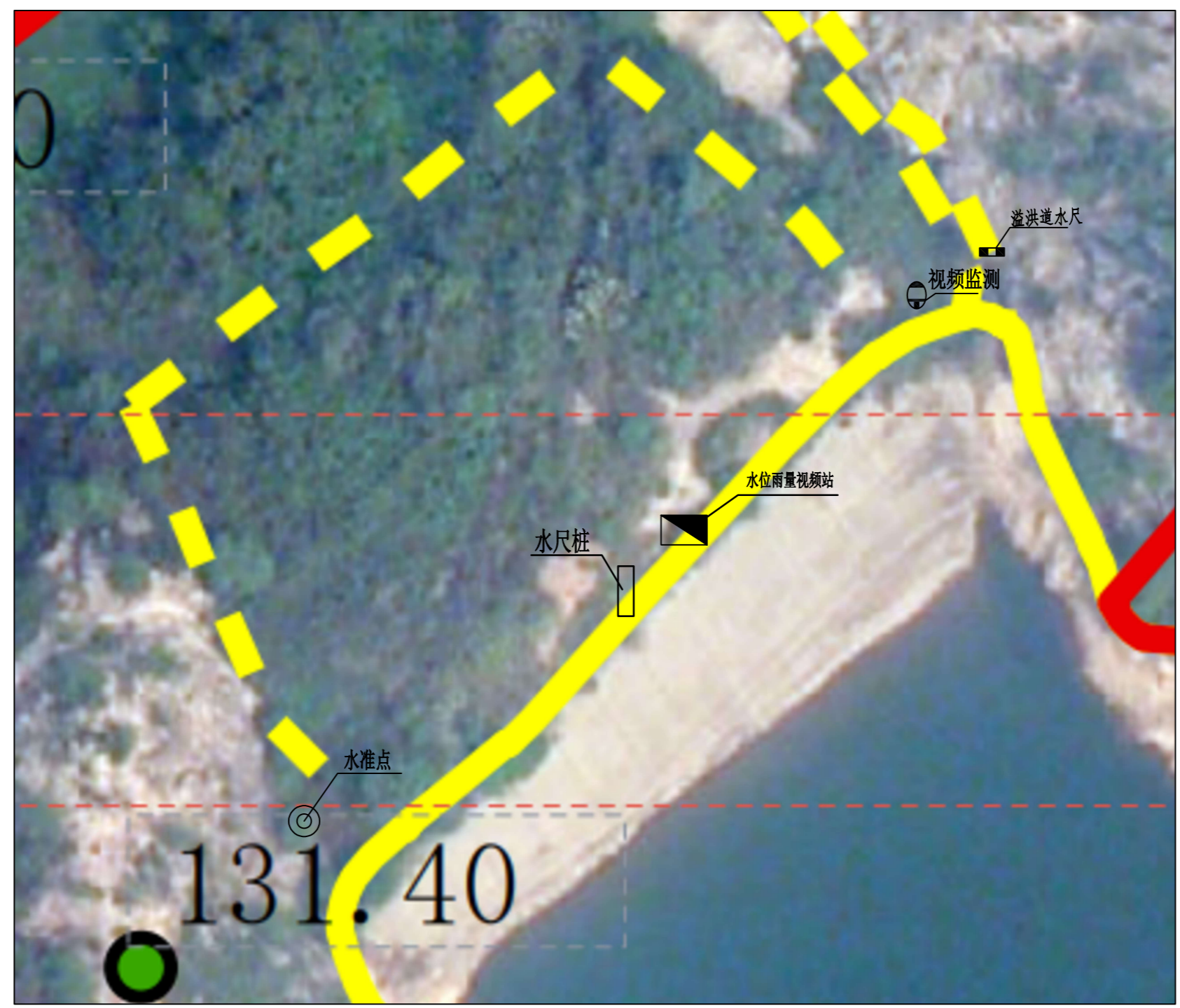
战备水库雨水情测报平面布置示意图
