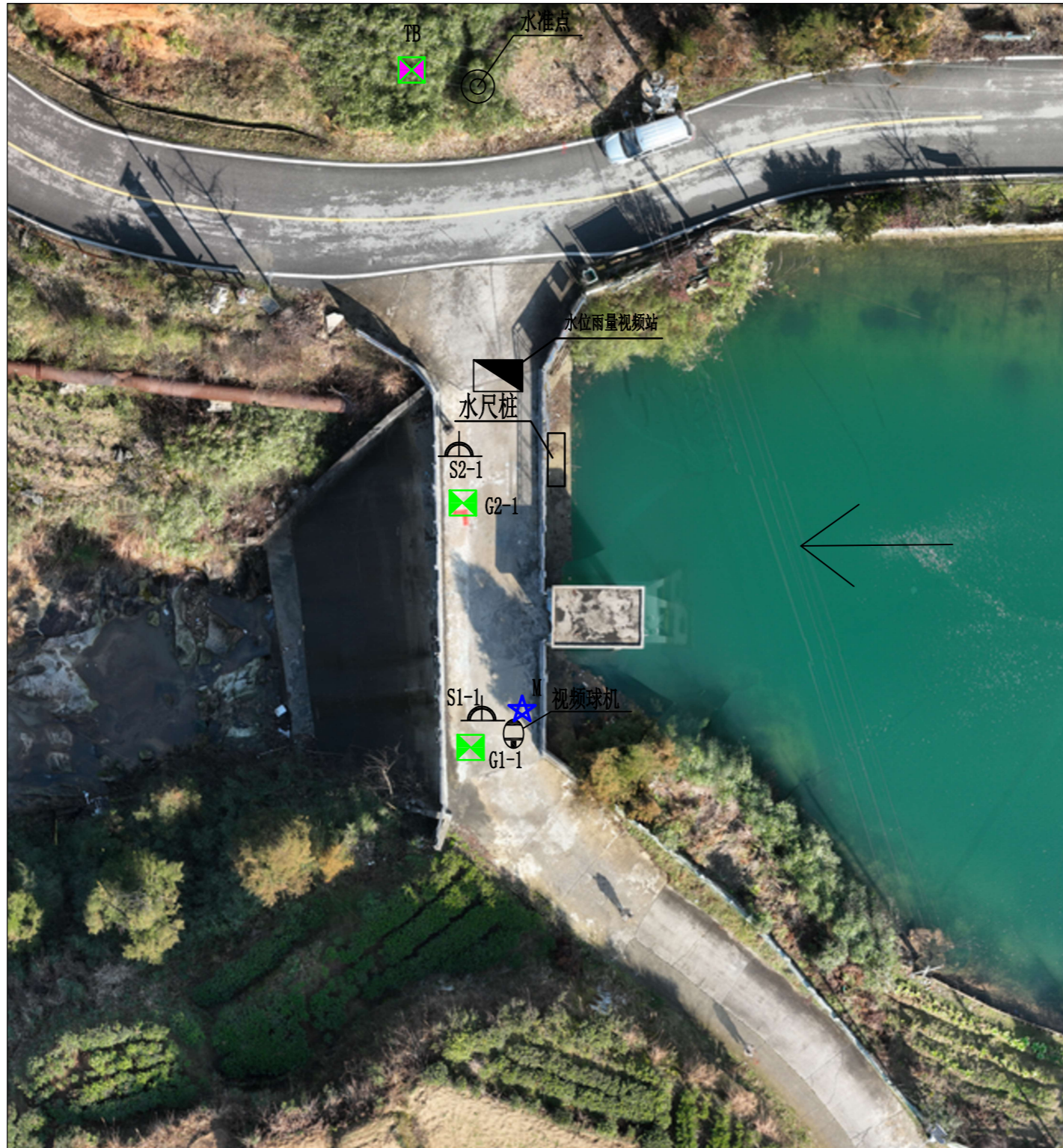
石旁神水库大坝安全监测平面布置示意图
