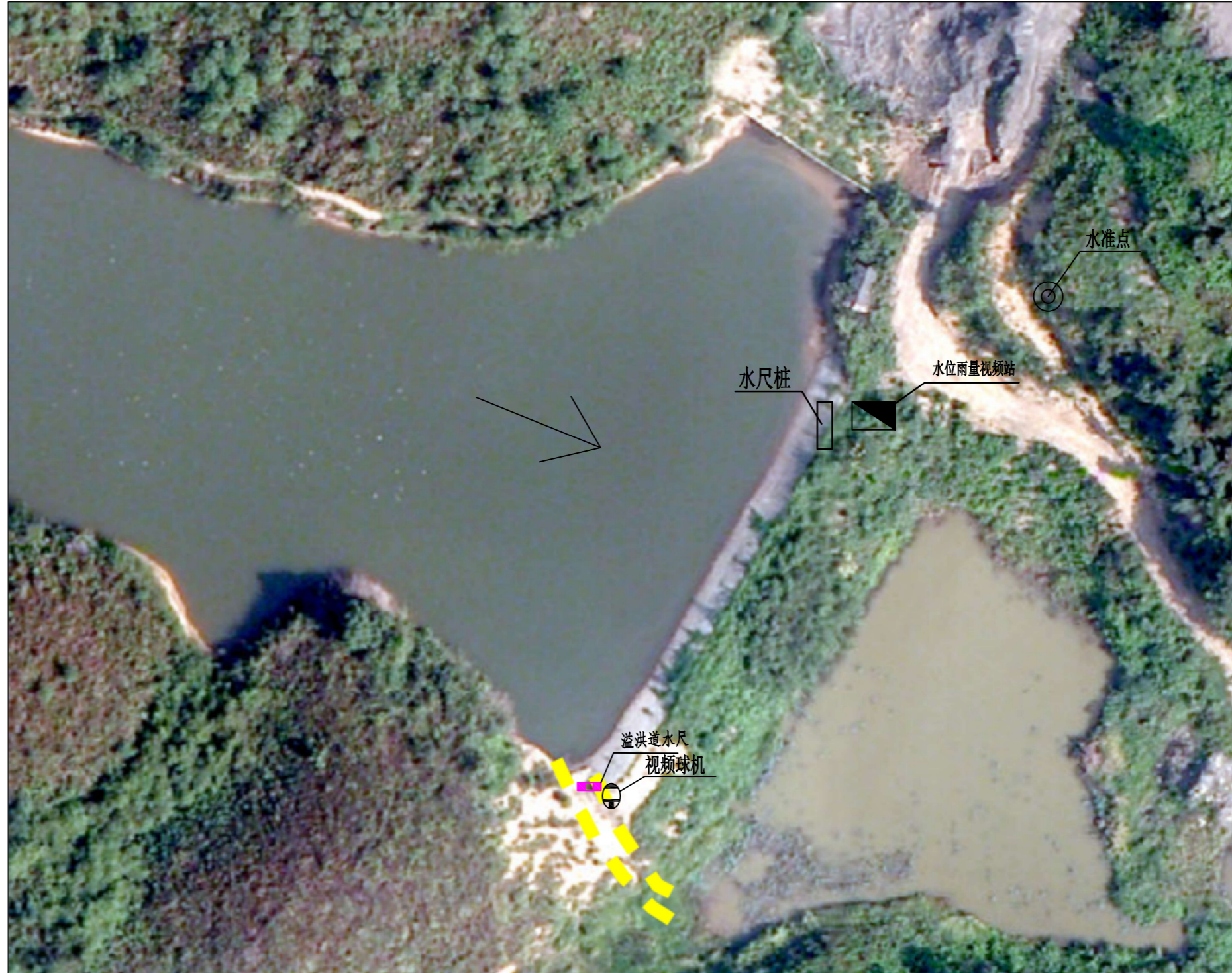
小生年水库雨水情测报平面布置示意图
